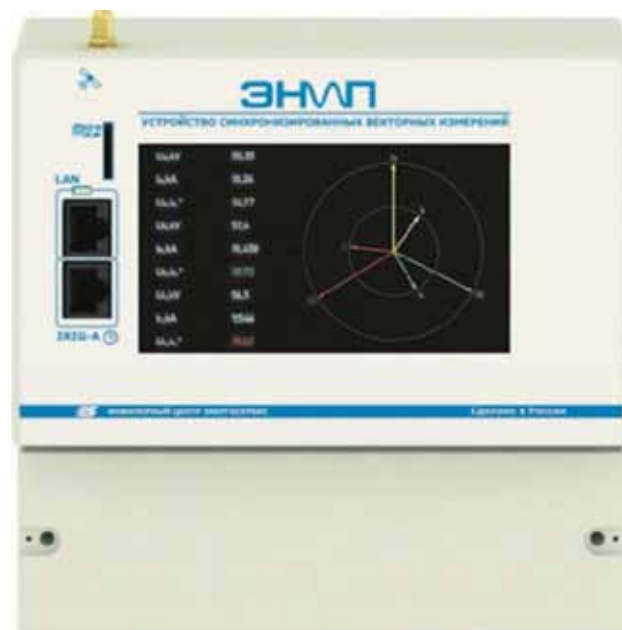
Рис. 4. Интеллектуальное электронное устройство ЭНИП-3
