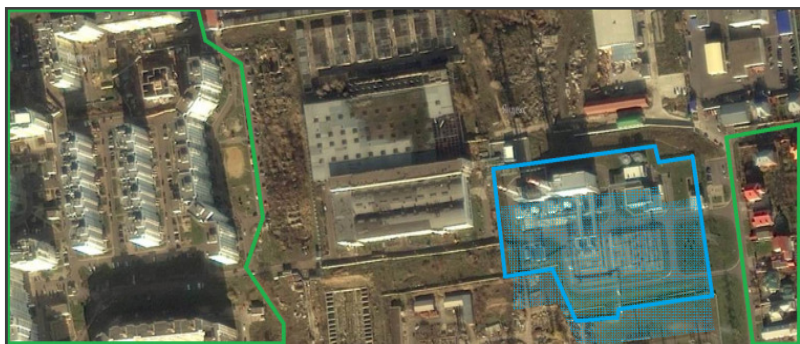
Белгород, ТЭЦ «Луч» 2 x LM2500+ (2 x 30 МВт) с КУ на отопление 196м x 145м
