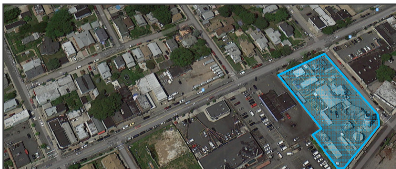
Нью-Йорк, ТЭЦ «NYRA» 1 x LM6000 (46 МВт) с паровым КУ 92м x 46м
