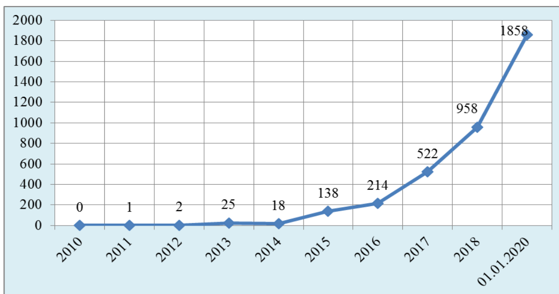
Рисунок 4.3 – Динамика установленной мощности объектов солнечной электроэнергетики в государствах-участниках СНГ в период с 2010 по 2020 годы, МВт
